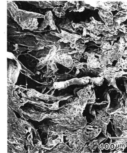
図4 コラーゲンスポンジのSEM像(×100) コラーゲンスポンジはコラーゲン線維からみあい海綿状構造を呈しており、100~200μmの空隙が観察された。
